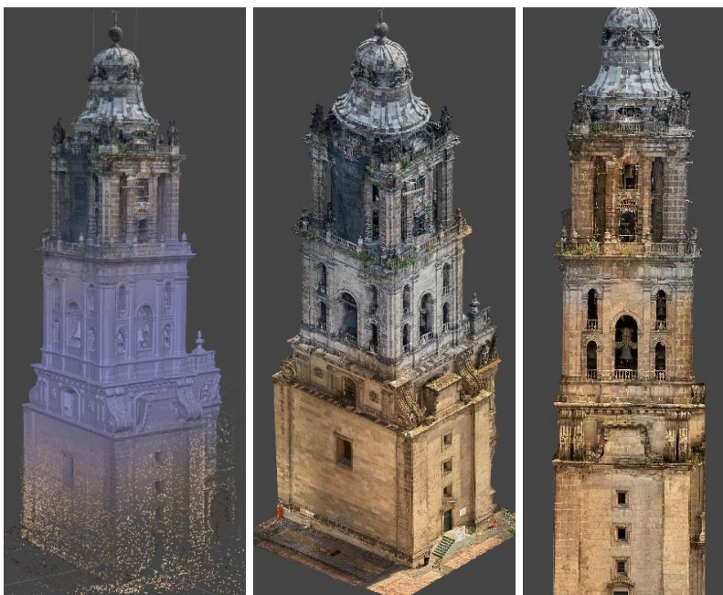
Figura 7. Construcción modelo 3d con fotogrametría, isométrico e imagen orto rectificada de la torre poniente de la Catedral Metropolitana.
