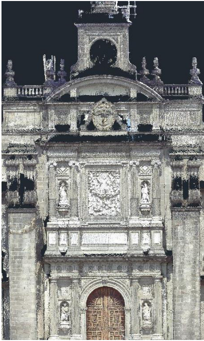
Figura 9. Nube de puntos obtenida con Escáner Láser Terrestre. Catedral Metropolitana CDMX.
