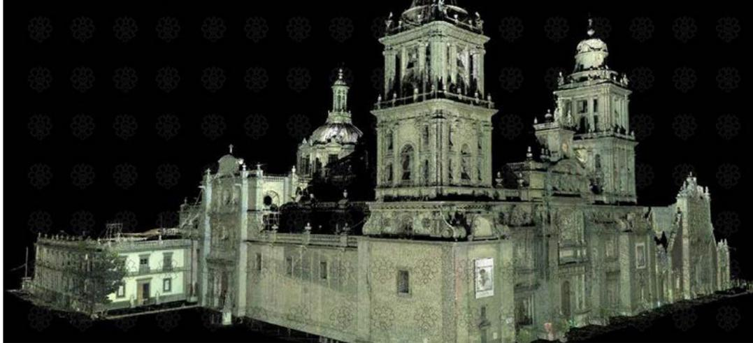
Imagen 1. Registro en nube de puntos realizada a partir del levantamiento arquitectónico tridimensional con escáner láser 3D de la Catedral Metropolitana. Trabajo realizado por el LIAD de la CNM-INAH.
